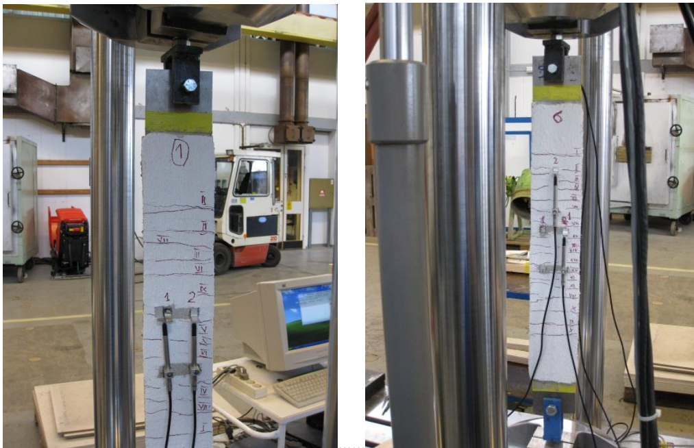
Figur 5.2.4 Sprickmönster vid höga värden på den påtvingade deformationen (töjning större än 5 mm/m). Sprickorna har markerats med röd spritpenna för att framhäva sprickmönstret.
