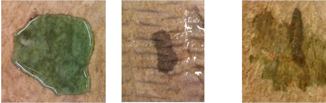
Figur 4.4.9 Exempel på skillnader i hydrofobering av isolering. Första bilden a) uppvisar normalt beteende där vattnet ligger på ytan, b) visar område där hydrofobering saknas och vattnet rinner rakt igenom, c) baksidan på samma område.
